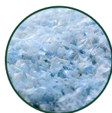
Reciclagem do Plástico Lavagem, moagem, extrusão, cristalização e pós-condensação
